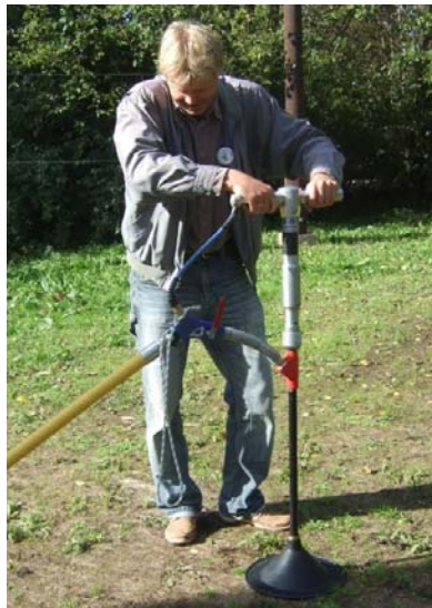
Olaf demonstriert ein pneumatisches Handgerät zur Tiefenlockerung nach Bodenverdichtungen.
